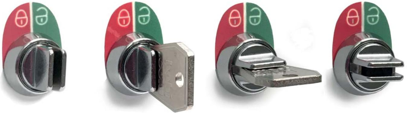
Pakettilaatikon lukko voidaan virittää valmiiksi niin, että **pakettilaatikon ovi voidaan avata yhden kerran ilman avainta**. Kun viritetty lukko suljetaan, se lukittuu. Lukitun pakettilaatikon saa auki vain avaimella.
