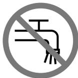
Vastavalt kehtivatele eeskirjadele ei tohi seadet ilma süsteemiseparaatorita joogiveevõrku ühendada. Kasutage süsteemiseparaatorit vastavalt IEC 61770 tüüp BA. Läbi süsteemiseparaatori voolanud vesi pole enam joogivesi.
