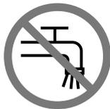
Zgodnie z obowiązującymi przepisami urządzenia nie wolno podłączać do sieci wody pitnej bez izolatora przepływu zwrotnego. Należy zastosować izolator przepływu zwrotnego zgodny z normą europejską IEC 61770 typu BA. Woda, która przepłynęła przez izolator przepływu zwrotnego, traci właściwości wody pitnej.
