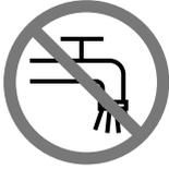
Laitetta ei voimassa olevien määräysten mukaan saa liittää juomavesiverkkoon ilman järjestelmän erotusta. Käytä standardin IEC 61770 tyyppi BA:n mukaista järjestelmän erotinta. Järjestelmän erottimen läpi virtaava vesi ei ole enää juomavettä.
