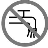
Az érvényben lévő előírásoknak megfelelően a készüléket nem szabad rendszerleválasztás nélkül csatlakoztatni az ivóvízhálózatra. Használjon az IEC 61770 előírásainak megfelelő BA típusú rendszerleválasztót. A rendszerleválasztón átfolyó víz már nem tekinthető ivóvíznek.
